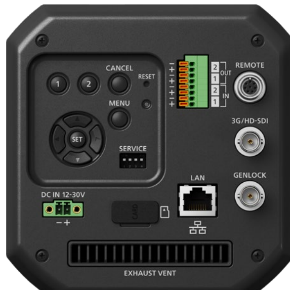
Die Rückseite des aktiv gekühlten Kameragehäuses vereint Bedienelemente, Anschlüsse für Stromversorgung und Fernsteuerung, eine LAN-Schnittstelle sowie Videoausgänge für das Full-HD-Signal.
